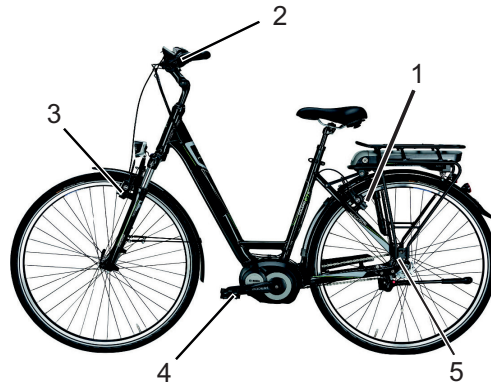
Abbildung 8: Bremssystem eines Fahrrads mit einer Rücktrittbremse, Beispiel
