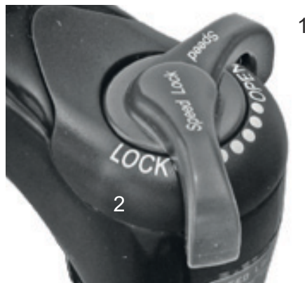
Abbildung 60: Suntour-Druckstufeneinsteller mit den Positionen OPEN (1) und LOCK (2)
