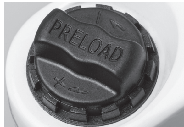
Abbildung 40: Einstellrad SAG auf der Krone der Federgabel
