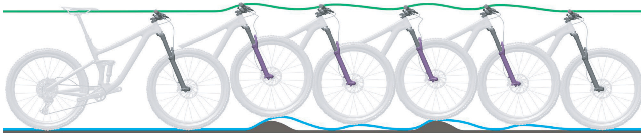
Abbildung 66: Zu schnelles Ausfedern der Federgabel
