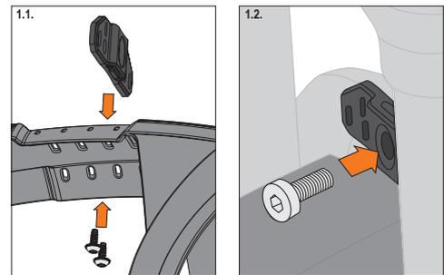
1.1. Adapter je nach benötigtem Lochbild auf dem Radschutz verschrauben. Hierfür die beiliegenden selbststschneidenden Schrauben verwenden. (TX20)
