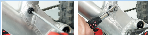
Abbildung 161: Postpin Achse befestigen
