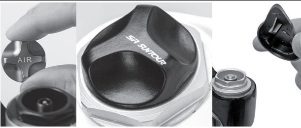
Abbildung 83: Schraubabdeckungen in unterschiedlichen Ausführungen
