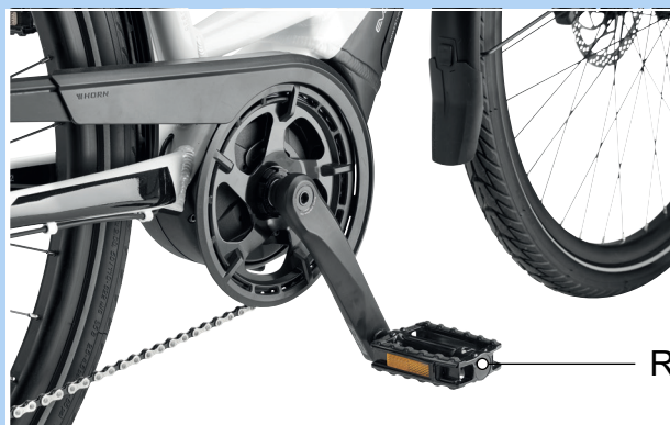
Abbildung 54: R-Pedal im rechten Kurbelarm
