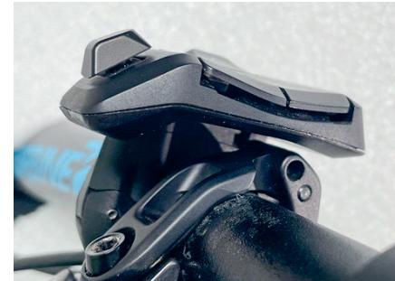
**DE** Beim steileren Anstellen gewisser Bremsen kann die Klemmschelle der Bremse mit der Unterseite des Bedienelements Remote Basic in Kollision geraten. Um eine Beschädigung zu vermeiden, soll ein Distanzstück montiert werden, welches für einen grösseren Abstand sorgt. Das gewährleistet den benötigten Freiraum, für die individuelle Bremseinstellung.
