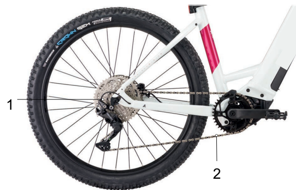
Abbildung 32: Schema Kettenantrieb mit Kettenschaltung
