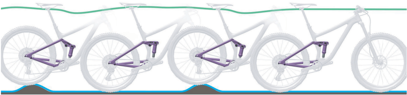
Abbildung 114: Optimales Fahrverhalten des Hinterbau-Dämpfers
