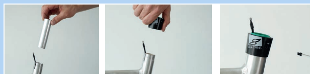
Abbildung 183: Gleitbuchse und Außenhülse einbauen
