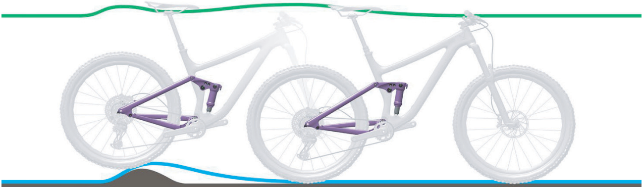
Abbildung 245: Zu harte Dämpfung des Hinterbau-Dämpfers bei Unebenheiten
