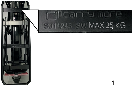
Abbildung 126: Auf dem Gepäckträger ist seine maximale Tragfähigkeit (1) ausgewiesen.
