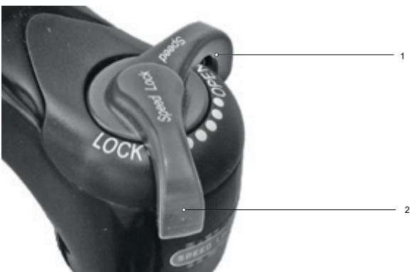
Abbildung 226: Druckstufeneinsteller härter einstellen
