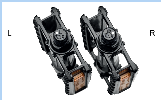
Abbildung 80: Beispiel Kennzeichnung von Pedalen
