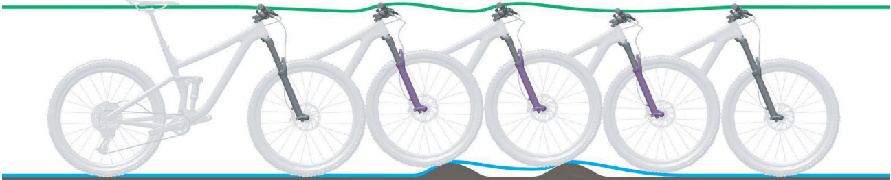
Abbildung 231: Zu langsames Ausfedern der Federgabel
