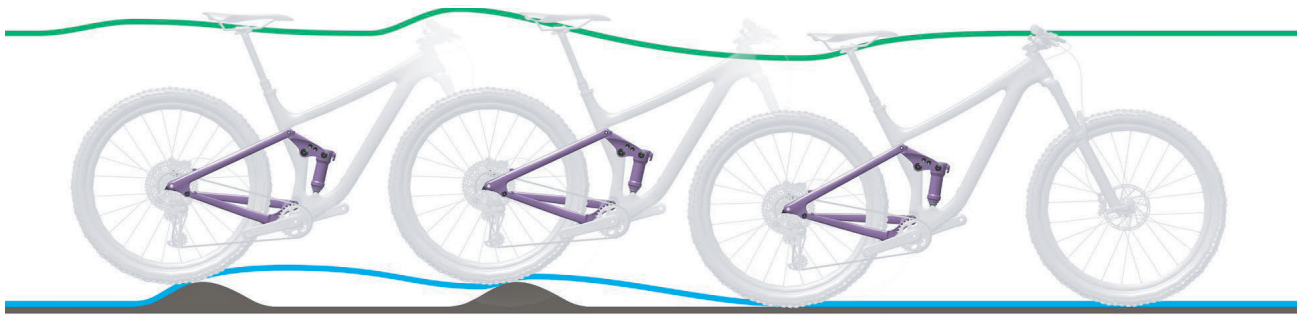
Abbildung 241: Zu langsames Ausfedern des Hinterbau-Dämpfers
