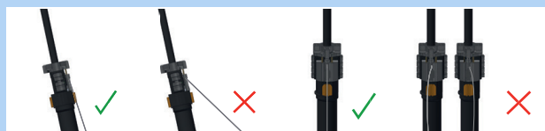
Abbildung 186: Korrekter und falscher Bowdenzug
